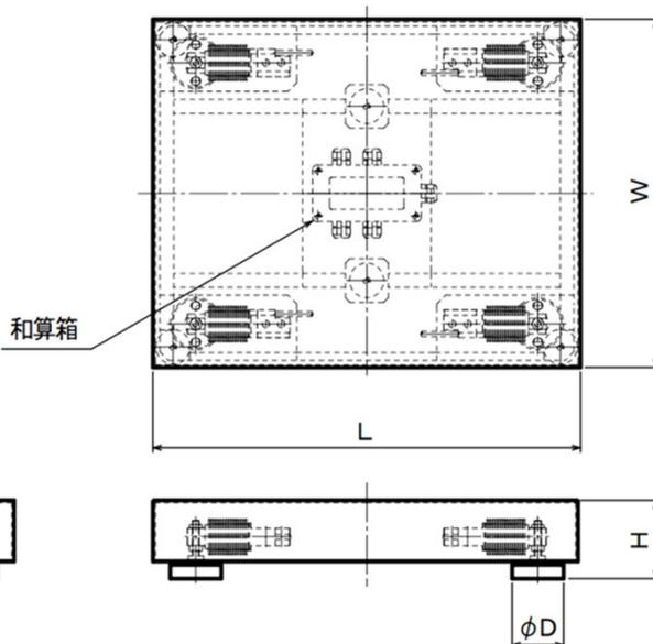
本体:SS製 塗装仕上 / 天板カバー式:SUS製パフ仕上#300 (BFP-SPシリーズ)
