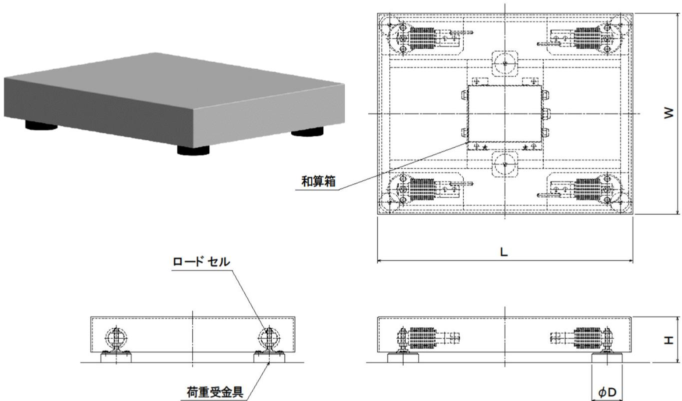
ロードセル(SUS製) 4点式 台秤 材質:SUS製(本体・天板カバー) FPシリーズ
